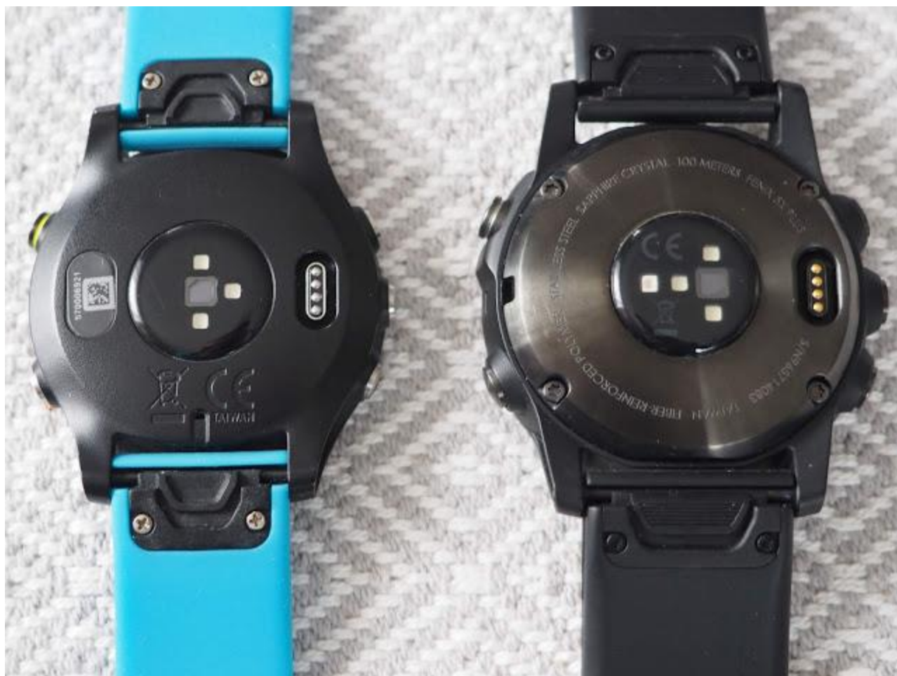
srovnání Fenix 5x plus a Forerunner 935 - FR935 je sice specifikací blíže ke staršímu modelu Fenix 5, ze kterého vychází Fenix 5 plus, ale konstrukčně z hlediska konektoru "jde" spíše do Fenix 5x plus
