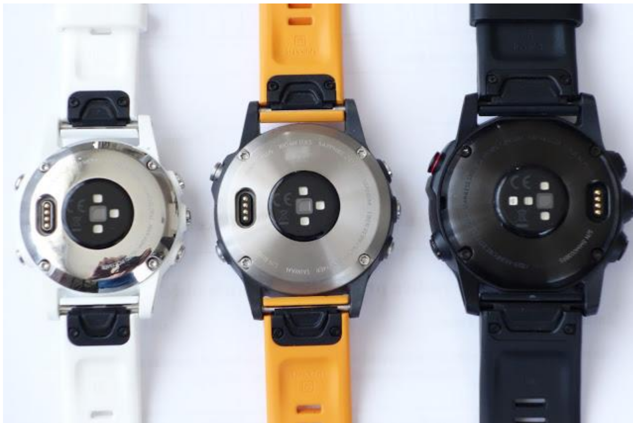
rozdílné umístění konektoru na dně hodinek Fenix 5x plus vs. Fenix 5s plus a Fenix 5 plus
