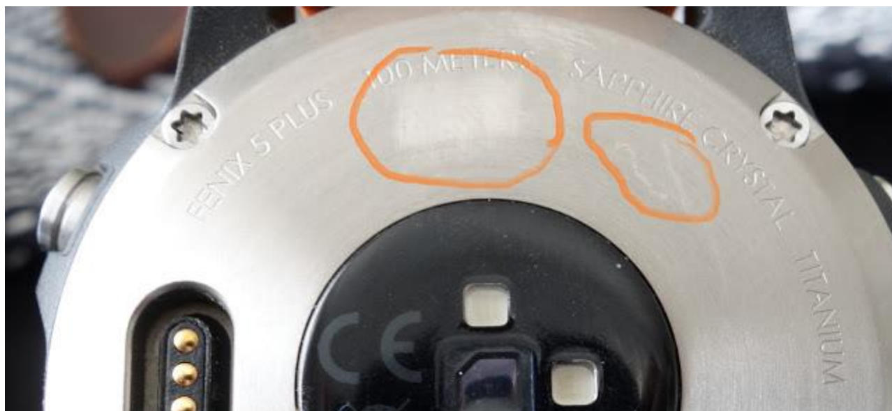
lehce vybroušené místo v titanovém dně hodinek po delší jízdě na kole s "volněji" uchycenými hodinkami na klasickém držáku (gumovém na špalku)
